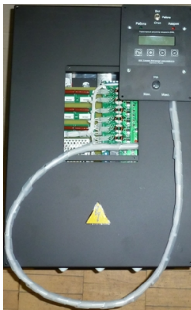
Рисунок 3.2 Выпрямитель ZTVN с вынесенной панелью управления
