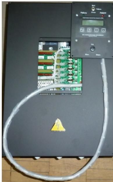
Рисунок 3.2 Регулятор ZVEL с вынесенной панелью управления
