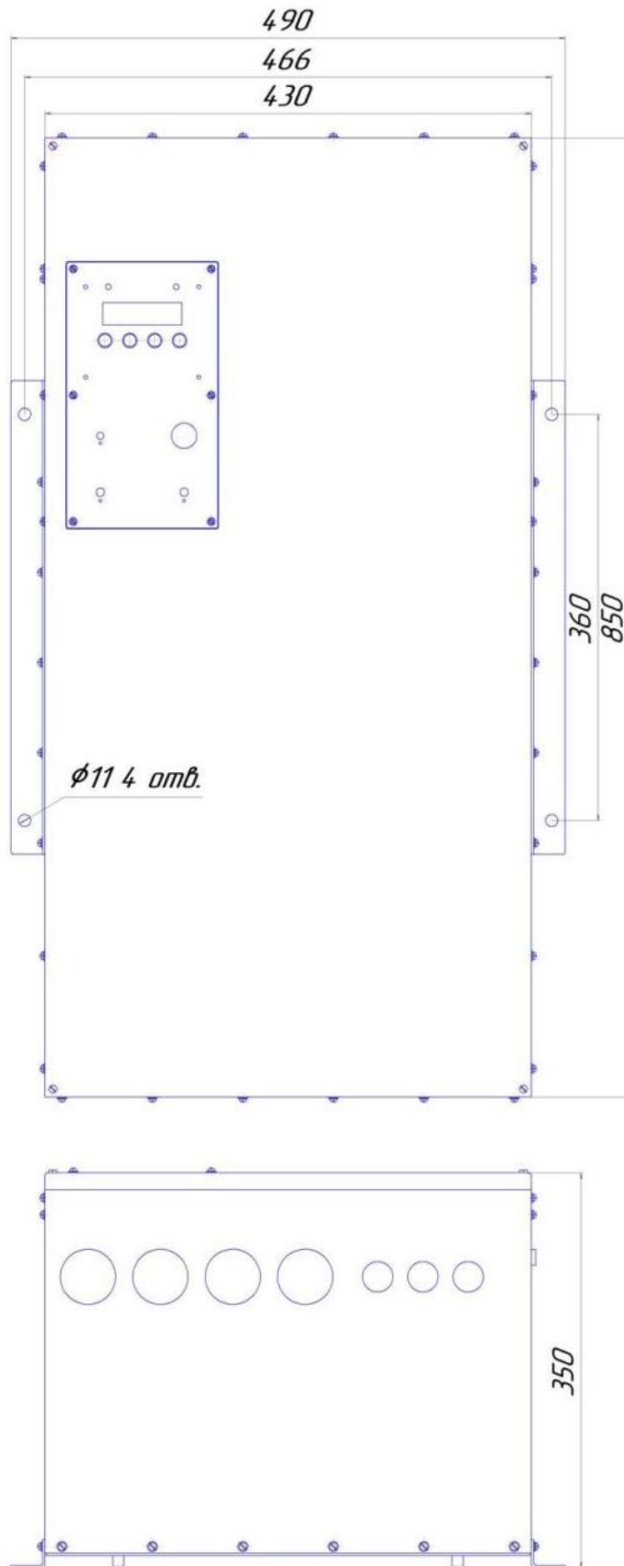
Рисунок Б8 Навесной вариант использования RBP-R-M-120-100, RBP-R-M-120-125, RBP-R-M-120-150. Крепежные уголки – слева и справа.
