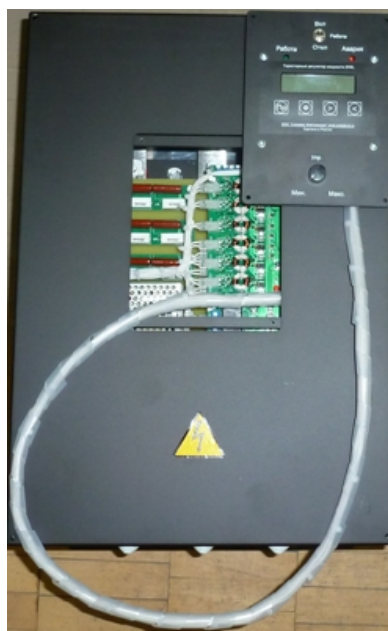
Рисунок 3.2 Регулятор ZTRS-RV-TY с вынесенной панелью управления
