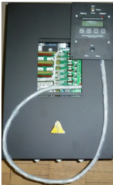
Рисунок 3.2 Выпрямитель ZTVN с вынесенной панелью управления
