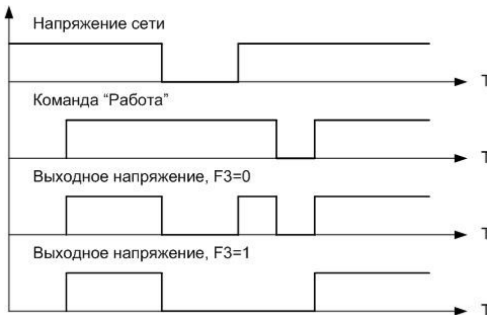
Рисунок 3.2 Применение функции F3
