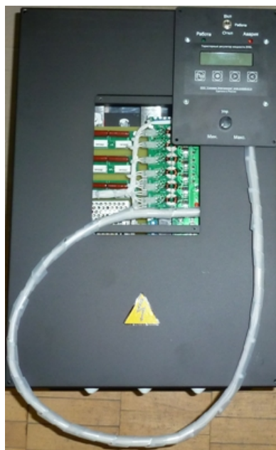
Рисунок 3.2 Регулятор ZTRS-TY с вынесенной панелью управления
