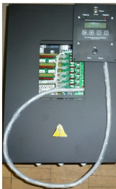
Рисунок 3.2 Регулятор ZTRS-RV с вынесенной панелью управления
