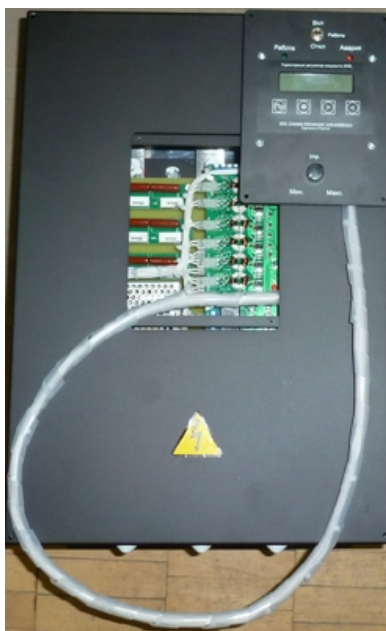
Рисунок 3.2 Выпрямитель ZTVN-3-R с вынесенной панелью управления
