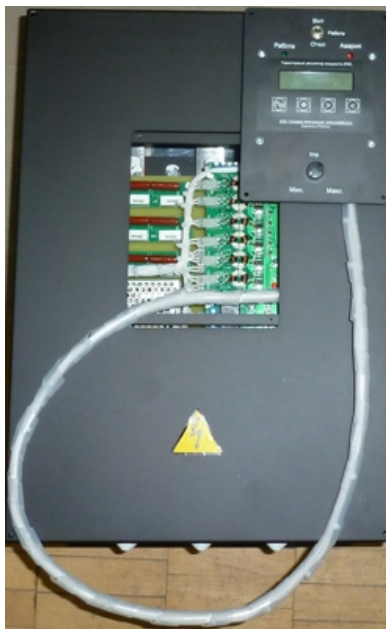
Рисунок 3.2 Регулятор ZTRS-TY с вынесенной панелью управления
